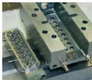
Iniezione diretta di 16 cavità in spazio molto ridotto
