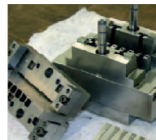
Montaggio ed aggiustaggio dello stampo
